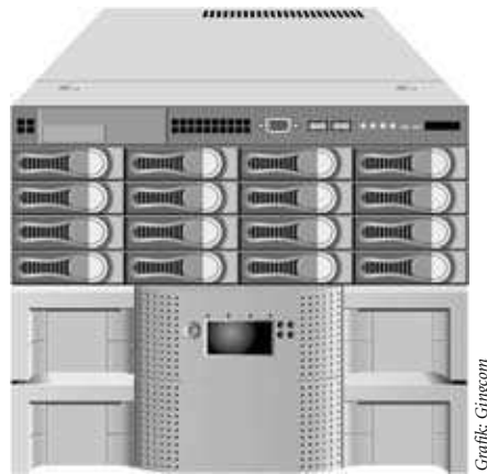
Die Gingcom »T2.2« kombiniert Festplatten- und Bandspeicher in einer Appliance.
